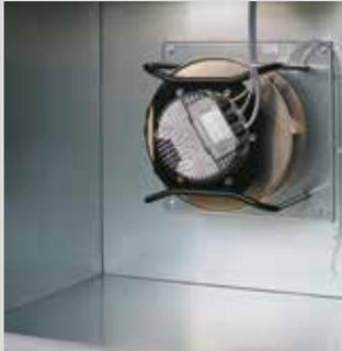
Ventilateur hélico-centrifuge hautement efficace, à une seule admission, avec couplage direct au moteur EC 50 ou 60 Hz, classe énergétique IE4. Réglage progressif de vitesse via signal de commande 0 - 10 V.
