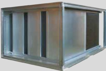
Coulisses en fibre minérale à flux d'air optimisé (testées selon DIN EN ISO 7235) avec recouvrement de film, classe de matériaux A1 (inflammable selon DIN 4102), recouvertes sur un côté d'un matériau absorbant et réfléchissant, scellées dans un cadre en tôle d'acier galvanisé, surface hydrofuge, lavable et résistant à l'usure jusqu'à 20 m/s, largeur de coulisse 200 mm.
