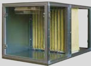
Filtre à poches clipsé, pressé sur un joint isolant inerte à pores fermés, desserrable à la main, démontable côté air chargé. Pas de contact avec le sol et donc exécution conforme VDI 6022 des filtres à poches.
