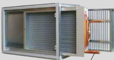
Avec refroidisseur d'air haute performance, en tant que batterie à détente directe. Raccordement d'agent de refroidissement avec distributeur pour injection multiple. Tuyaux en Cu à ailettes alu haute performance pressées, optimisées et profilées, collecteur en cuivre, montage sur un cadre en tôle d'acier galvanisée.
