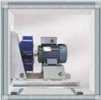
Unité moteur / ventilateur avec hélice libre haute performance, courbée vers l'arrière et montée directement sur l'arbre moteur. Ossature anticorrosion assemblée par vissage. Unité complète fixée sur des profilés en C et désolidarisée grâce à des silentblocs.
