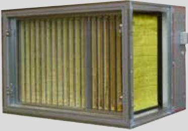
Filtre à poches démontable par le côté de série, pressé sur un joint isolant inerte à pores fermés par un dispositif de serrage rapide, desserrable à la main, exécution selon VDI 6022. Résiste à la température de 30 °C à 90 °C et 100 % h.r.
