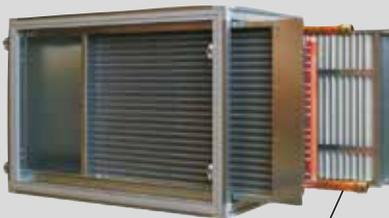
Avec refroidisseur d'air à l'eau froide extractible (pression de fonctionnement admissible 16 bar, pression de contrôle 30 bar), tuyaux en Cu à ailettes alu haute performance pressées, optimisées et profilées, collecteur en cuivre, montage sur un cadre en tôle d'acier galvanisée, convient pour fonctionnement avec pompe à eau froide.
