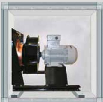
Unité ventilateur / moteur avec hélice libre haute performance, courbée vers l'arrière, exécution antidéflagrante selon ATEX 100 (vernis conducteur de courant, rotor à buse d'admission en laiton ou cuivre et moteur hermétique conforme aux Directives ATEX)
