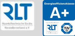
Définit des nouveaux labels d'efficacité énergétique sur base de la norme EN 13053 A1 2010. L'évaluation porte sur la classe de vitesse, la puissance électrique absorbée par le moteur de ventilateur [classe P] et le rendement énergétique de la récupération de chaleur [classe H].
